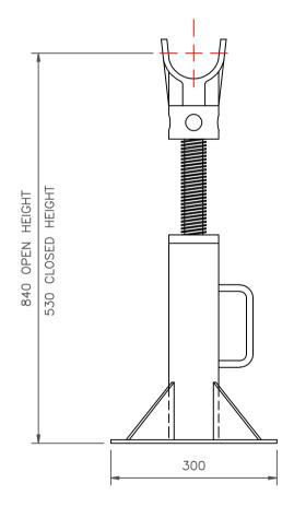
CABLE DRUM JACKS EASY TO HANDLE AND SIMPLE OPERATION.
