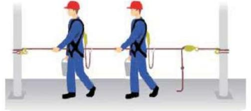
Apta para su uso donde exista un riesgo de caída factor 2. Importante: Es necesario combinar el dispositivo de anclaje con un dispositivo que disipe la energía generada durante una caída (absorbedor de energía, dispositivo retráctil...)
